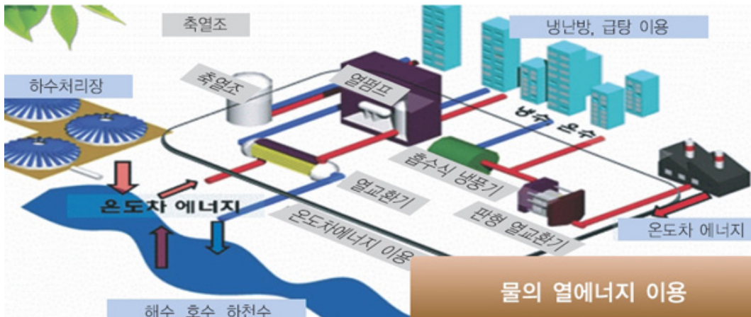
[그림 5] 해수열원 열펌프를 이용한 냉난방시스템 구성요소
